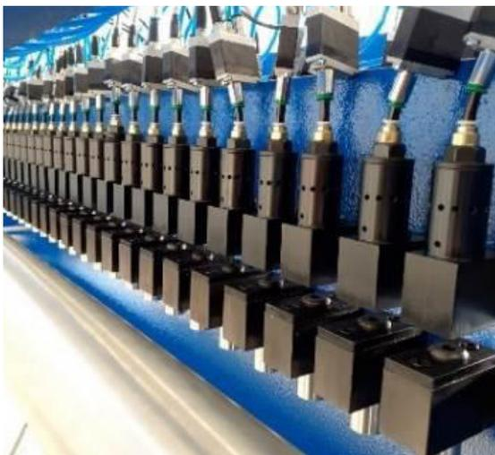
**IMPIANTO** di macro foratura **A INGOMBRO RIDOTTO** per praticare **MACRO FORI** di vari diametri e forme **SU MATERIALE IN MOVIMENTO**, in particolare per il **FILM NEUTRO O STAMPATO** da integrare come unità ospite in linee di trasporto film come taglierine, estrusori, macchine da stampa, saldatrici, macchine per sacchetti ed in tutte le linee di lavorazione di **FILM IN MARCIA**.
